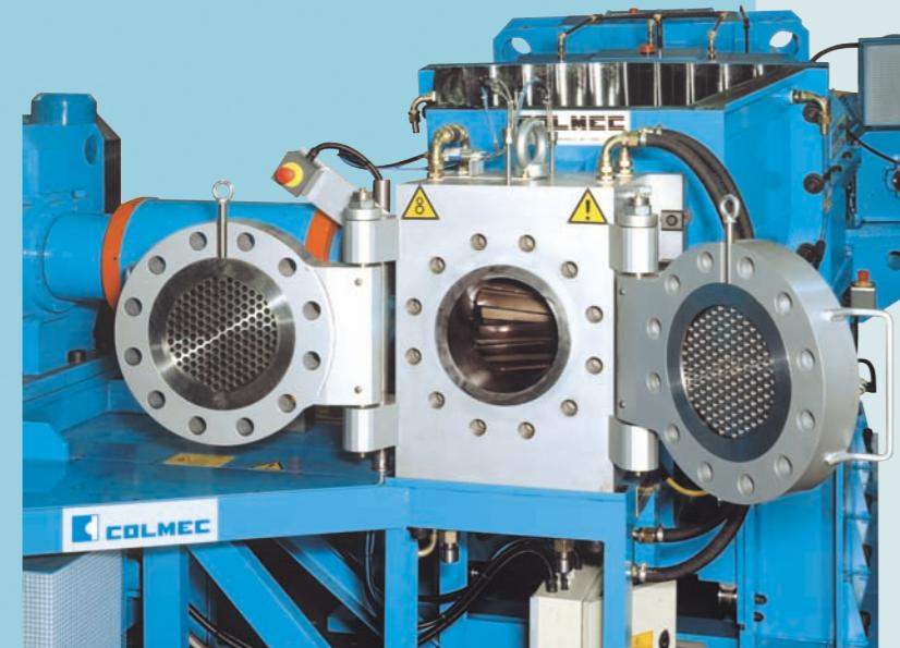
HOT STRAINING WITH GEAR PUMP **GP 225**
